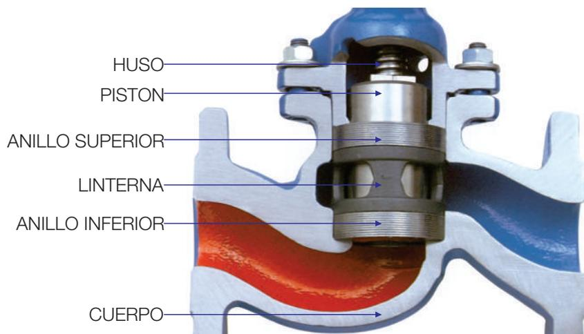
El sellado a pistón de las válvulas Klinger se basa en el contacto entre el pistón (plug) y la superficie interna de los anillos de sellado, el contacto con el anillo inferior (asiento) proporciona el corte del flujo a la tubería y el contacto con el anillo superior sella la atmósfera. El sello del pistón con el anillo superior reemplaza las empaquetaduras trenzadas y la junta de sello del bonete, componentes obligatorios en las válvulas convencionales.
